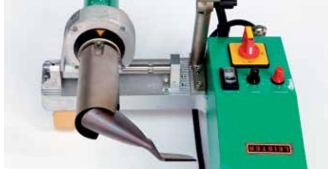
Сварочный автомат горячего воздуха
