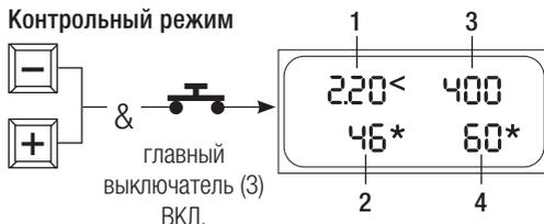
Управление сварочным процессом и поиск неисправностей при выводе на экран значений энергопотребления.
