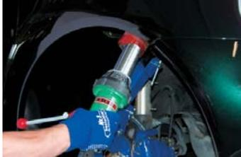
Использование аппарата ЭЛЕКТРОН для ускорения процесса сушки лака, краски и шпатлевки.
