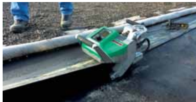
Геостар без проблем сварил около 240 метров шва за один проход во время полевых испытаний (в Южной Африке).
