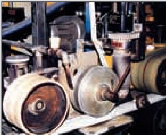
Нагреватели 5000 при сварке бесконечного шланга и ПВХ.
