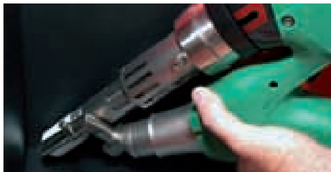
WELDPLAST S1 с подсветкой в зоне сваривания позволяет лучше контролировать сварочный процесс в труднодоступных местах.
