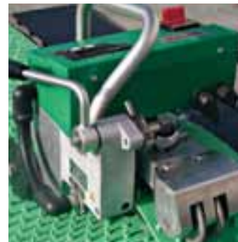
Спец. версия для сварки защитной гидроизоляции для бетона.
