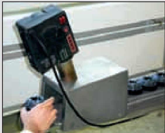
Тепловентилятор с рефлекторной туннельной насадкой сушит краску после тампонной печати.
