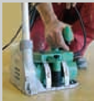
Шаг 1: разделка шва аппаратом GROOVER.
