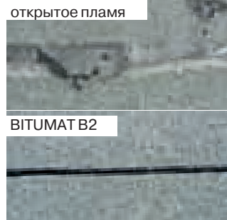
Однозначно лучший результат по сравнению со сваркой открытым пламенем.
