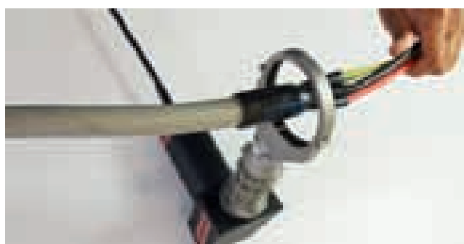
Термоусадка с помощью аппарата GIBLI
