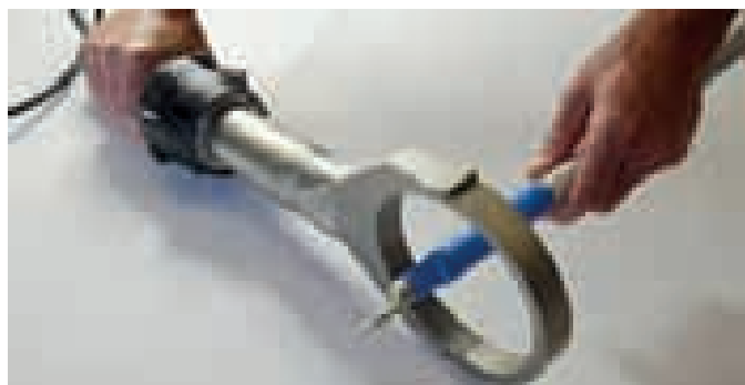
Процесс термоусадки при помощи аппарата ELECTRON ST.
