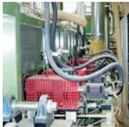
Воздухонагреватели LHS производственной линии для теплоизоляции.
